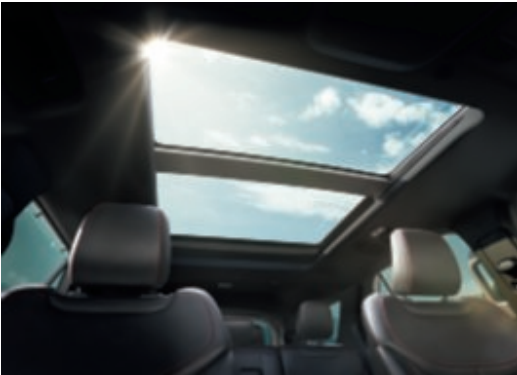
Kétpaneles, elektromos működtetésű panorámatető
